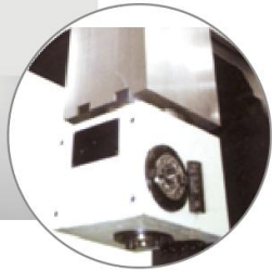
五面体头最小分割单位标配5度可选配1度，定位精度1秒
